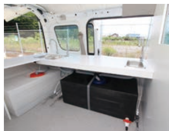
給水・排水タンクともに80Lタンク
